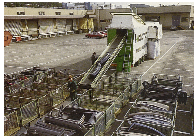
Lökhárítók anyagának térfogatcsökkentő őrlését végző mobil shredder
