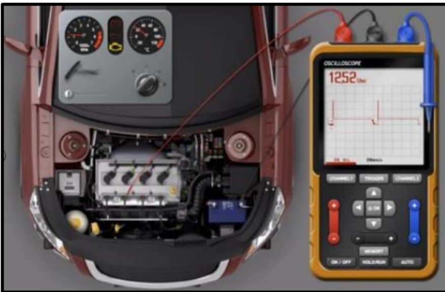
Motorvezérlő rendszer diagnosztikájának a szimulációja (forrás: Maróti Könyvkereskedés Kft., Electude program tanári kézikönyv)
